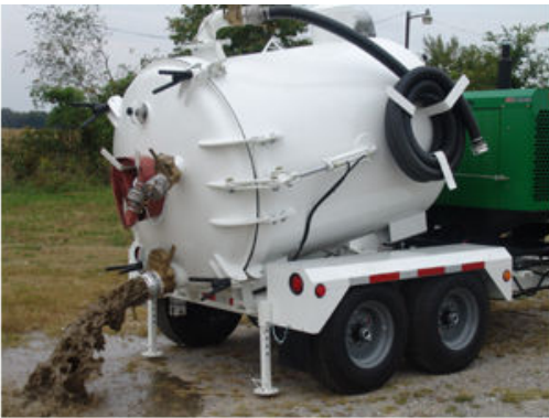
Drenagem por válvula 150 mm diâmetro
