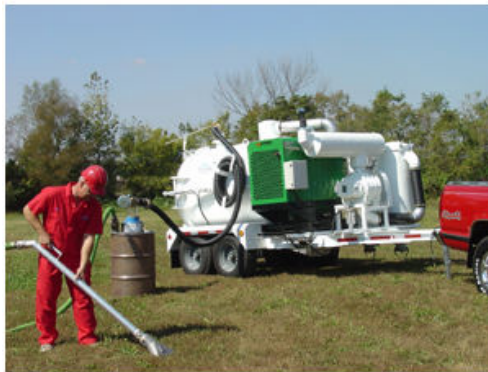
Opcional: aspiração para tampor através da tampa de vácuo Drumit .
