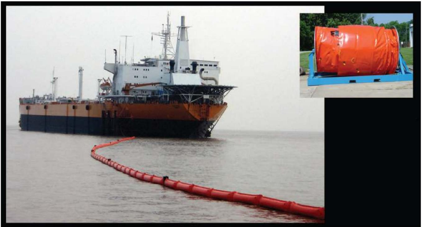
A barreira Airmax é fabricada em tela duradoura 29oz/1000 gsm, usando um processo especial que garante a melhor integridade das câmaras-de-ar. O lastro é providenciado por uma corrente galvanizada, protegida por uma bolsa reforçada.
