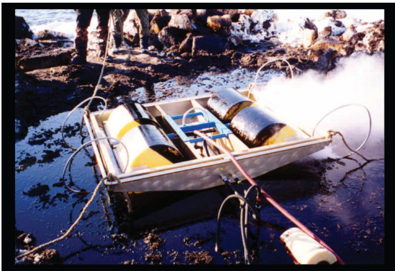
Tambores de elevada capacidade de recolha – elevado intervalo de viscosidade – peso reduzido – trabalho à superfície
