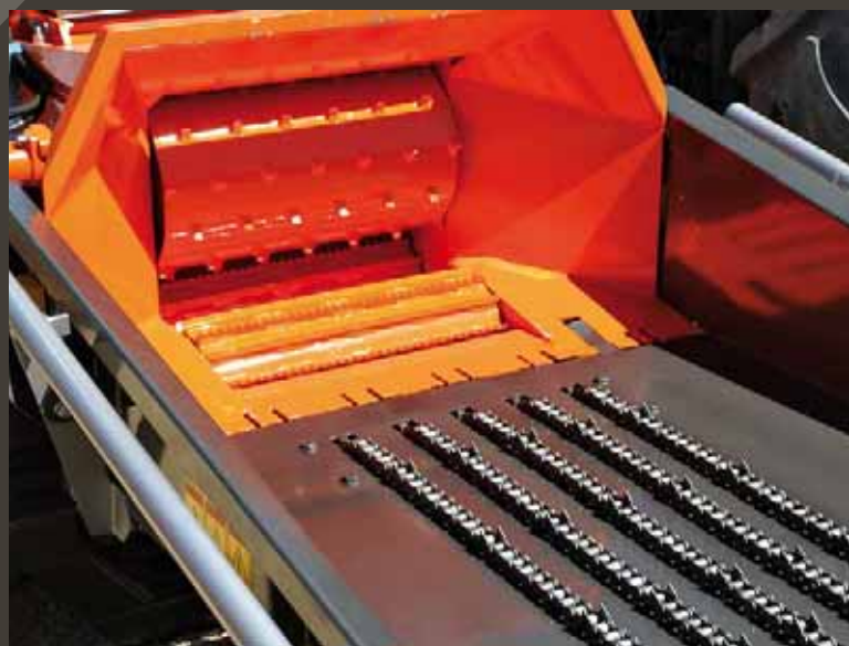
Rolo compactador e tapete em correntes de aço dentadas.
