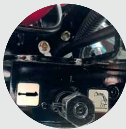
Pré-instalação hidráulica para carregador frontal
