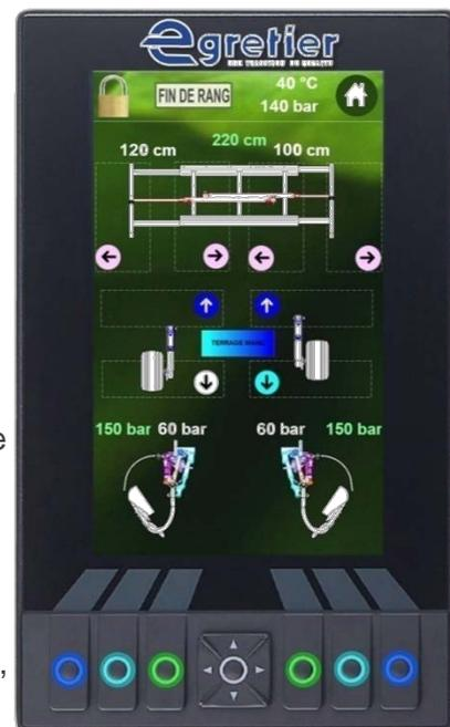
A interface touchscreen na cabine permite o ajuste automático da ferramenta e informa ao motorista em tempo real os parâmetros de largura, recentralização automática, segurança anti-obstáculo para vinhas torcidas, profundidade das lâminas independentes (inclinação), força das ferramentas no chão e nas vinhas,....
