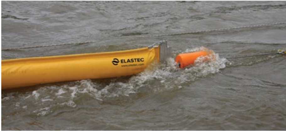
Brida de remolque con flotador de bala
