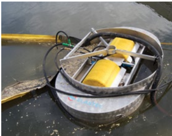
Skimmer de circo con vertedero interno
