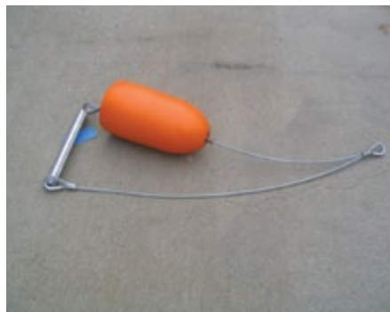
Freio de reboque com bala flutuante
