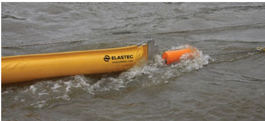
Freio de reboque com bala flutuante
