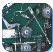
SISTEMA DE AUTO-LUBRIFICAÇÃO
