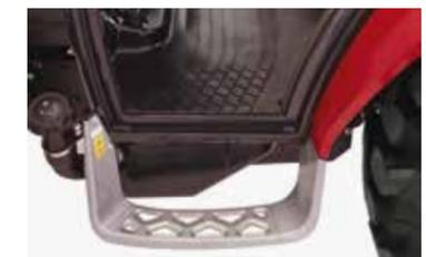
Plataforma plana e larga com piso anti-derrapante
