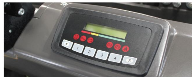
Ecrã LCD multifunções, controla fácil do desempenho e estado de funcionamento através da informação em tempo útil
