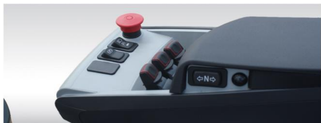
Sistema opcional de controlo tátil para subir e baixar, avançar, recuar, mover-se lateralmente, paragem de emergência, buzina, controlo de iluminação e outros botões de controlo num só.
