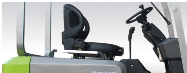
Assento com suspensão avançada que pode aliviar a fadiga do condutor e melhorar a eficiência de trabalho.
