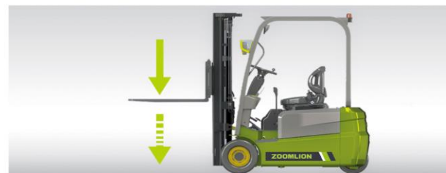
Sistema de amortecimento inteligente do mastro, a velocidade de descida reduzirá automaticamente para evitar que a mercadoria fique danificada pelo impacto.
