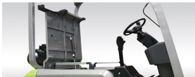
A tampa da bateria possui um suporte hidráulico e pode ser totalmente aberta, o que facilita a manutenção da bateria.
